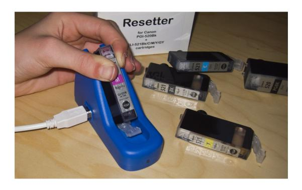
Mit Hilfe der Profi USB-Resetter werden refillte Tintentanks vom Drucker wieder als volle Tintentanks erkannt. Bei Multifunktionsgeräten mit Telefax ist somit auch der Einsatz von refillten Tintentanks für den Telefaxbetrieb möglich. Da die Füllstandsanzeige erhalten bleibt wird ein leerdrucken des Druckkopfes wirksam verhindert.
